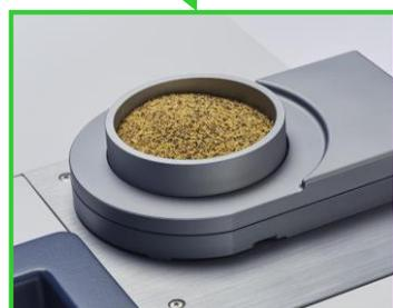
拡散反射測定
