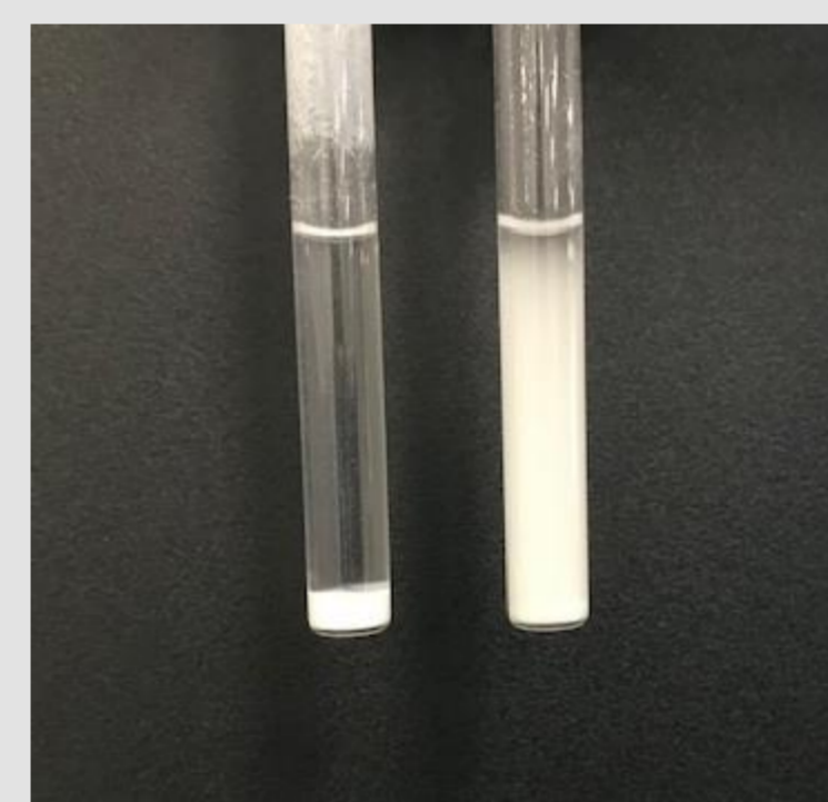
Fig.4 粉体分散試料の例 分散沈降後 (左)、分散直後 (右)
