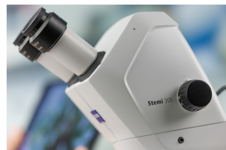
本体に高速カラーWi-FiカメラとWLANルーターを内蔵
