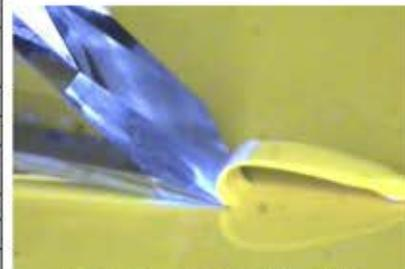
積層塗膜の分析用断面作製
