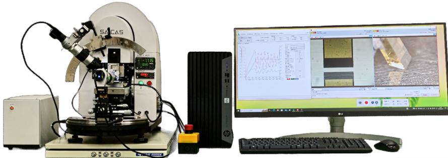
「塗膜の剥離強度測定」
